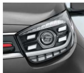
Projekcyjne lampy przednie ze światłami do jazdy dziennej LED.
