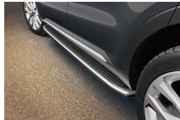
Stopnie boczne. Solidne stopnie boczne zapewniają łatwiejszy dostęp do wnętrza.
